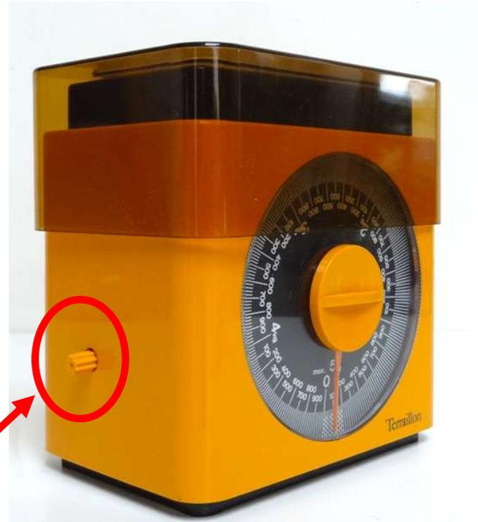
Servent à l'étalonnage du dispositif de mesure
