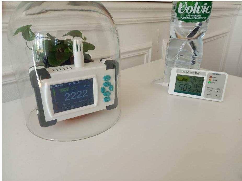
Pour vérifier qu'il ne s'agit pas d'une dérive du capteur, j'ai à la fin de l'expérience déplacé la cloche pour la mettre sur l'autre capteur. La valeur est montée à plus de 1000 ppm.
